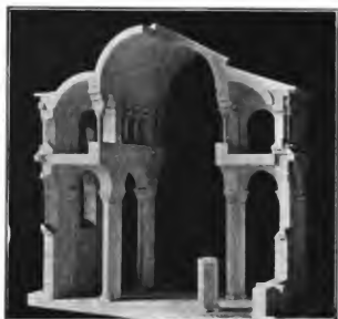
Fig. 375.—Estructura de una iglesia románica. Catedral de Clermont-Ferrand.
