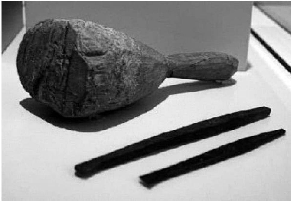
Figura 14.3. Maza de madera y cinceles de cobre egipcios. Museo Egipcio de Berlín (foto de M. a Rosa Valdesogo).
